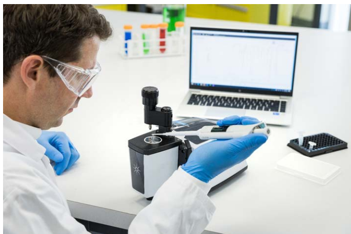
그림 1. Agilent Cary 630 FTIR을 단일 반사 다이아몬드 ATR 모듈과 함께 사용했습니다.
