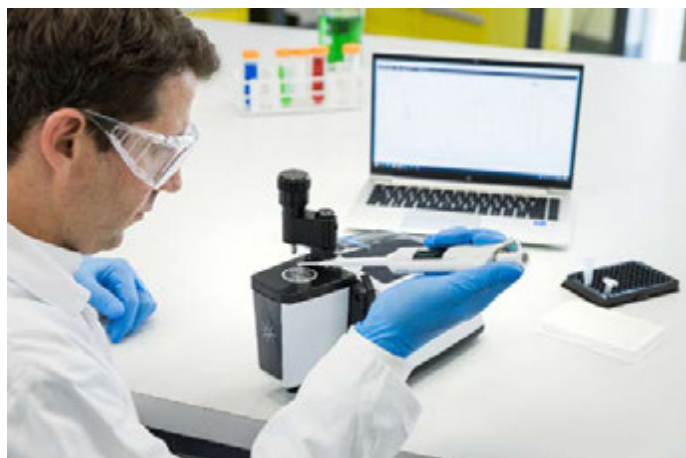
Figura 1. El espectrómetro FTIR Agilent Cary 630 se equipó con el módulo de ATR de diamante de reflexión única.
