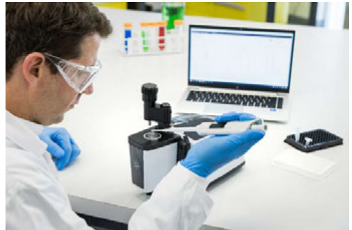
Abbildung 1. Das Agilent Cary 630 FTIR-Spektrometer wurde mit dem Diamant-ATR-Modul mit Einfachreflexion verwendet.
