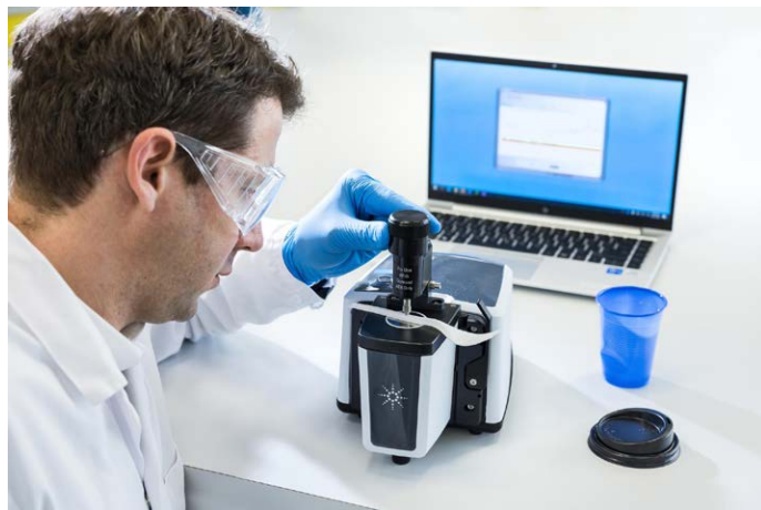
图 2. 配备钻石晶体衰减全反射 (ATR) 附件的 Agilent Cary 630 FTIR 光谱仪
