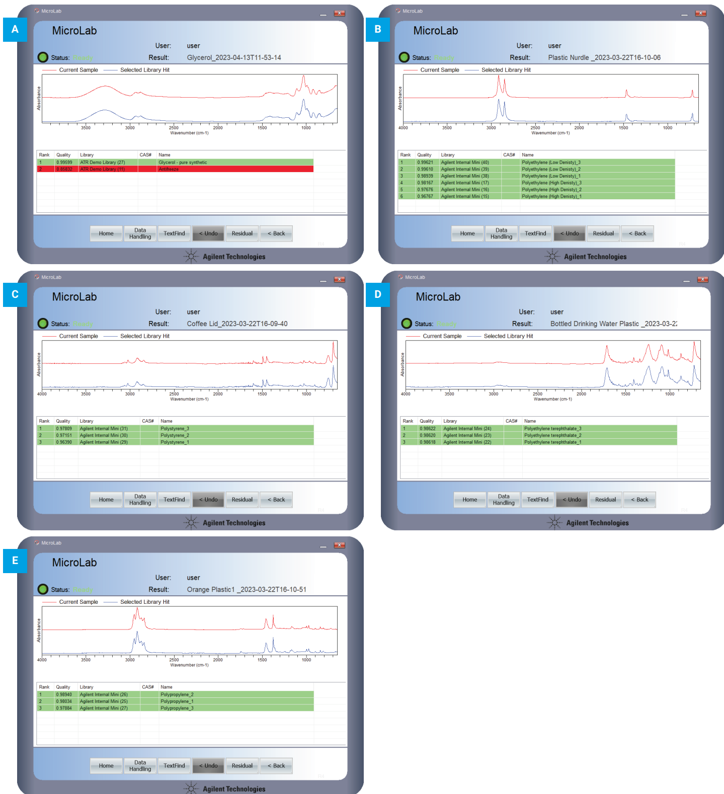
图 4. Agilent Cary 630 FTIR 光谱仪对五个塑料样品的定性分析结果（红色迹线）和谱库匹配结果（蓝色迹线）。表中显示了各样品的匹配质量、所用谱库和匹配结果名称；(A) 增塑剂；(B) 颗粒；(C) 咖啡盖；(D) 水瓶；(E) 风化塑料
