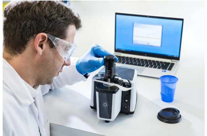
그림 2. 다이아몬드 감쇠 전반사(ATR) 모듈과 결합된 Agilent Cary 630 FTIR 분광기.
