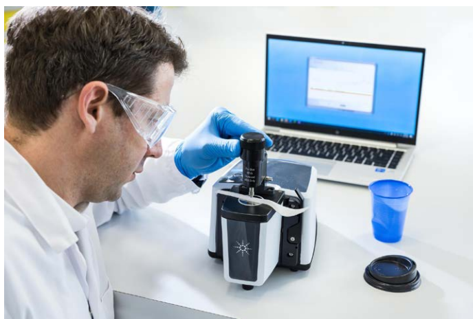
图 1. 配备钻石晶体衰减全反射 (ATR) 附件的 Agilent Cary 630 FTIR 光谱仪
