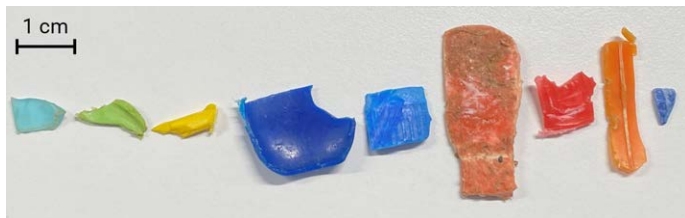
图 2. 从澳大利亚海滩收集并在本研究中使用 Agilent Cary 630 FTIR 光谱仪进行分析的塑料碎片
