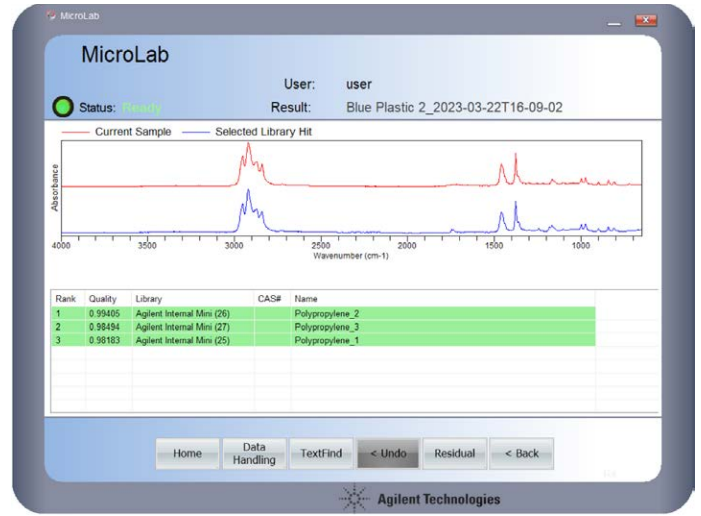
그림 3. Agilent Cary 630 FTIR 분광계의 플라스틱 파편(적색 트레이스) 및 라이브러리 히트(청색 트레이스) 정성 분석의 예입니다. 표에는 히트 품질, 사용된 라이브러리 및 각 샘플의 히트 이름이 표시됩니다. HQI를 기반으로 결과를 색상 코딩하여 신뢰 수준을 정의하는 데 사용할 수 있으므로 사용자가 결과를 해석하는 데 도움이 되고 간과하여 오류로 이어질 수 있는 가능성을 줄일 수 있습니다.
