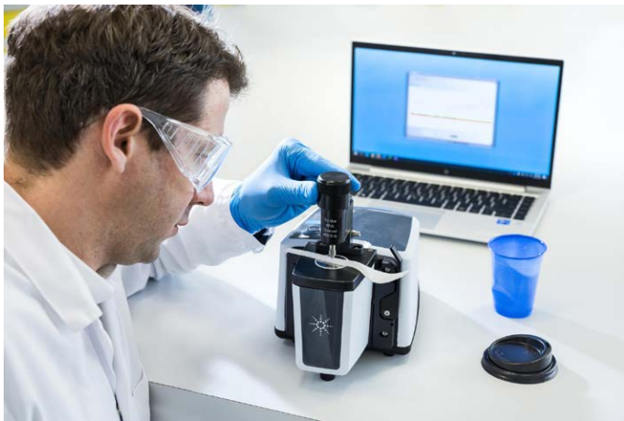
그림 1. 다이아몬드 감쇠전반사(ATR) 모듈에 결합된 Agilent Cary 630 FTIR 분광계.
