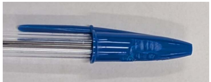
그림 9. 빠른 분석법과 기존 분석법으로 시험한 펜 뚜껑. 사진에서 볼 수 있듯이 뚜껑의 중간 부분을 얇게 잘라 시료를 채취했습니다.
