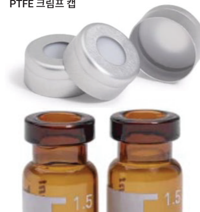
그림 6. 대체 애질런트 바이알과 캡이 실록산 간섭을 줄이는지 테스트했습니다. (A) 폴리우레탄 캡과 스냅 캡 바이알. (B) 알루미늄/PTFE 크림프 캡 및 크림프 캡 바이알.
