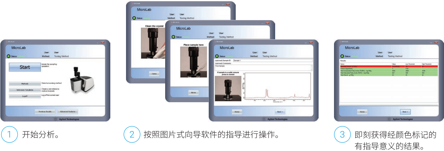
图 2. 使用 Agilent MicroLab 软件和安捷伦 FTIR 光谱仪，通过三个简单步骤即可完成分析，从而简化方法并有效减少培训需求
