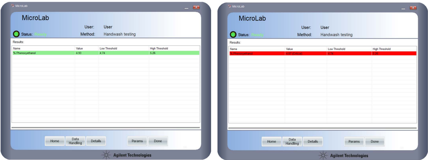
图 6. 将 Agilent Cary 630 FTIR-ATR 定量模型集成到 Agilent MicroLab 软件方法中，简化了杀菌洗手液批次的常规分析。该软件可在数据采集后确定百分比浓度，并提供经颜色标记的有指导意义的结果，以绿色表示合格样品，以红色表示不合格样品
