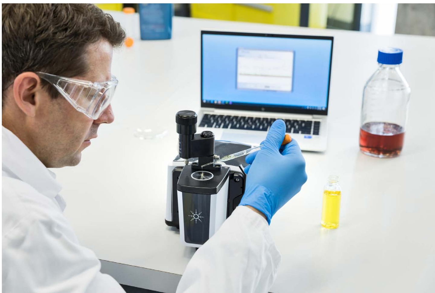
图 1. 配备钻石晶体 ATR 附件的 Agilent Cary 630 FTIR 光谱仪，是快速简便定量分析洗手液产品中苯氧乙醇的理想选择
