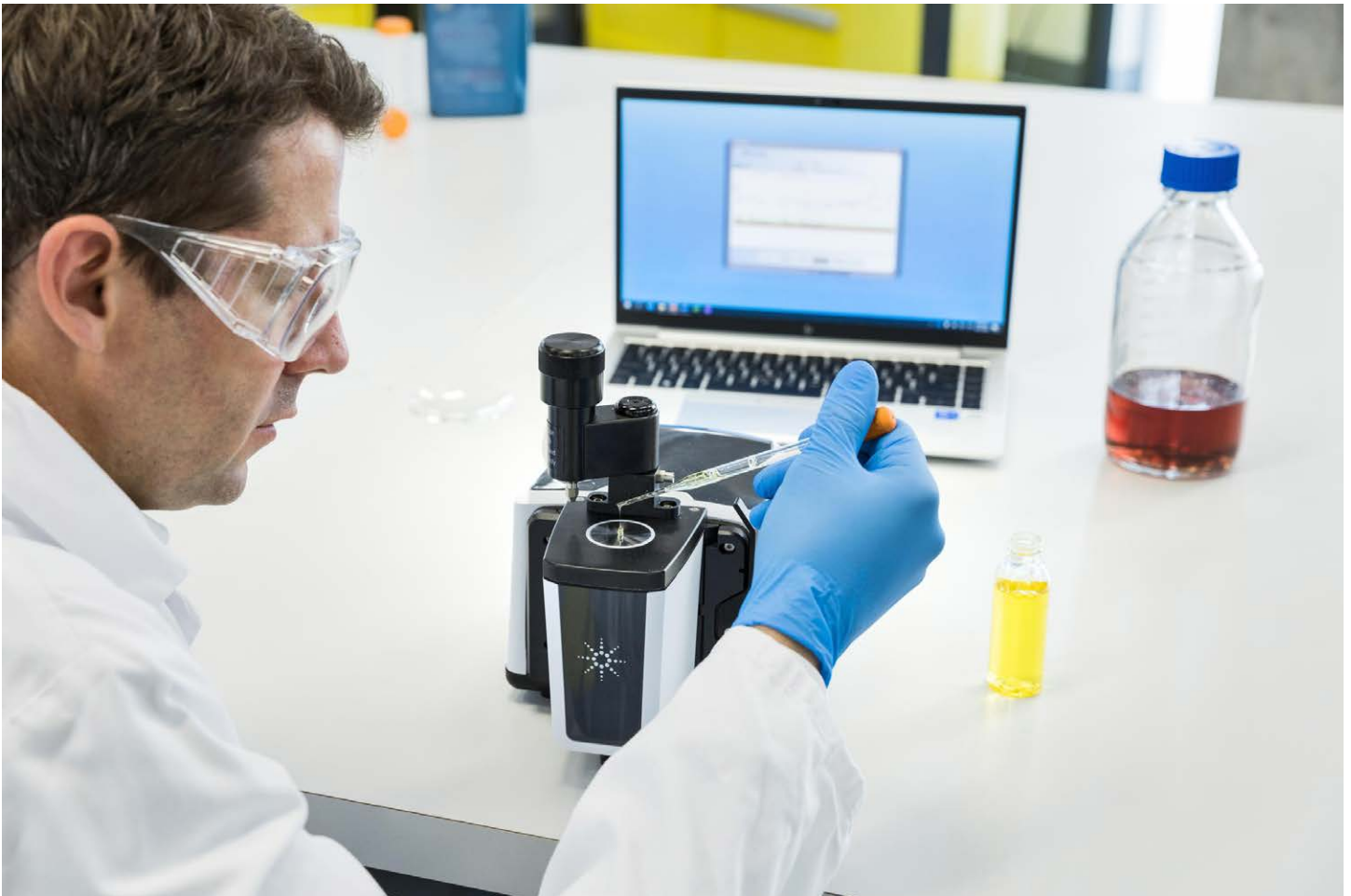
그림 1. 다이아몬드 ATR 모듈이 장착된 Agilent Cary 630 FTIR 분광기는 손 세정제 제품의 페녹시에탄올을 빠르고 간편하게 정량하는 데 이상적입니다.
