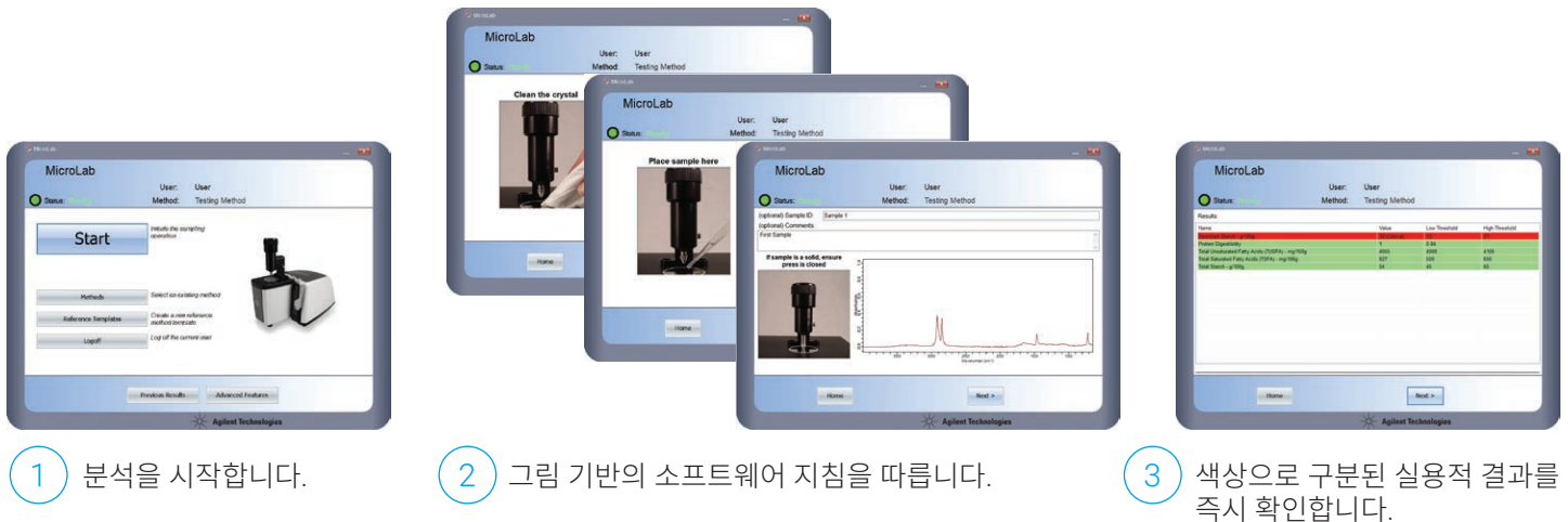
그림 2. Agilent MicroLab 소프트웨어와 Agilent FTIR 분광기를 사용하면 간단한 3단계로 분석을 수행할 수 있어 분석법을 간소화하고 교육 요구 사항을 최소화할 수 있습니다.
