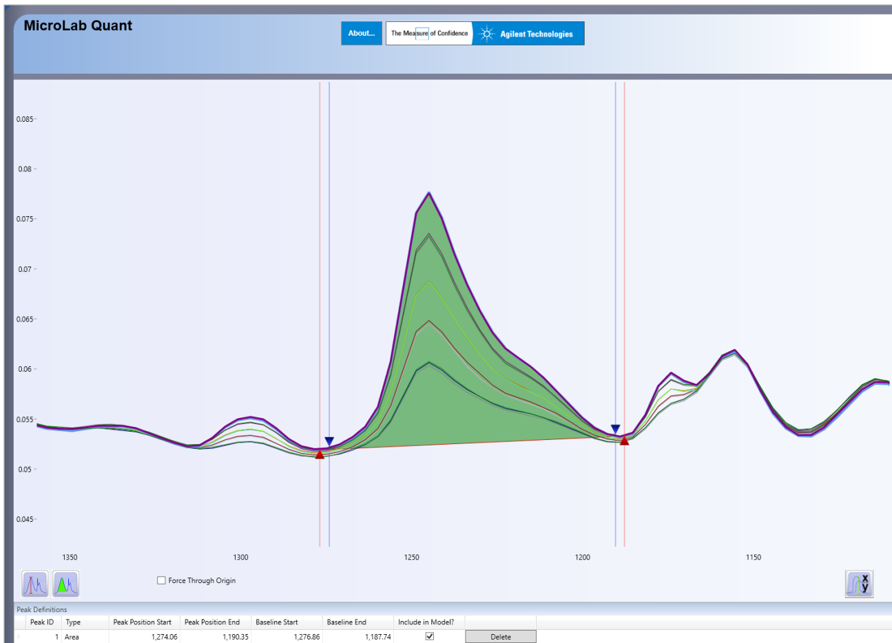
그림 3. Agilent MicroLab Quant 애플리케이션을 사용하면 분석물질 정량에 가장 적합한 밴드를 식별하여 피크 위치, 피크 시작점 및 종료점과 같은 분석 파라미터를 최적화할 수 있습니다. 페녹시에탄올의 1250cm -1 밴드는 뚜렷하게 구분되므로 검량선 생성에 적합합니다.
