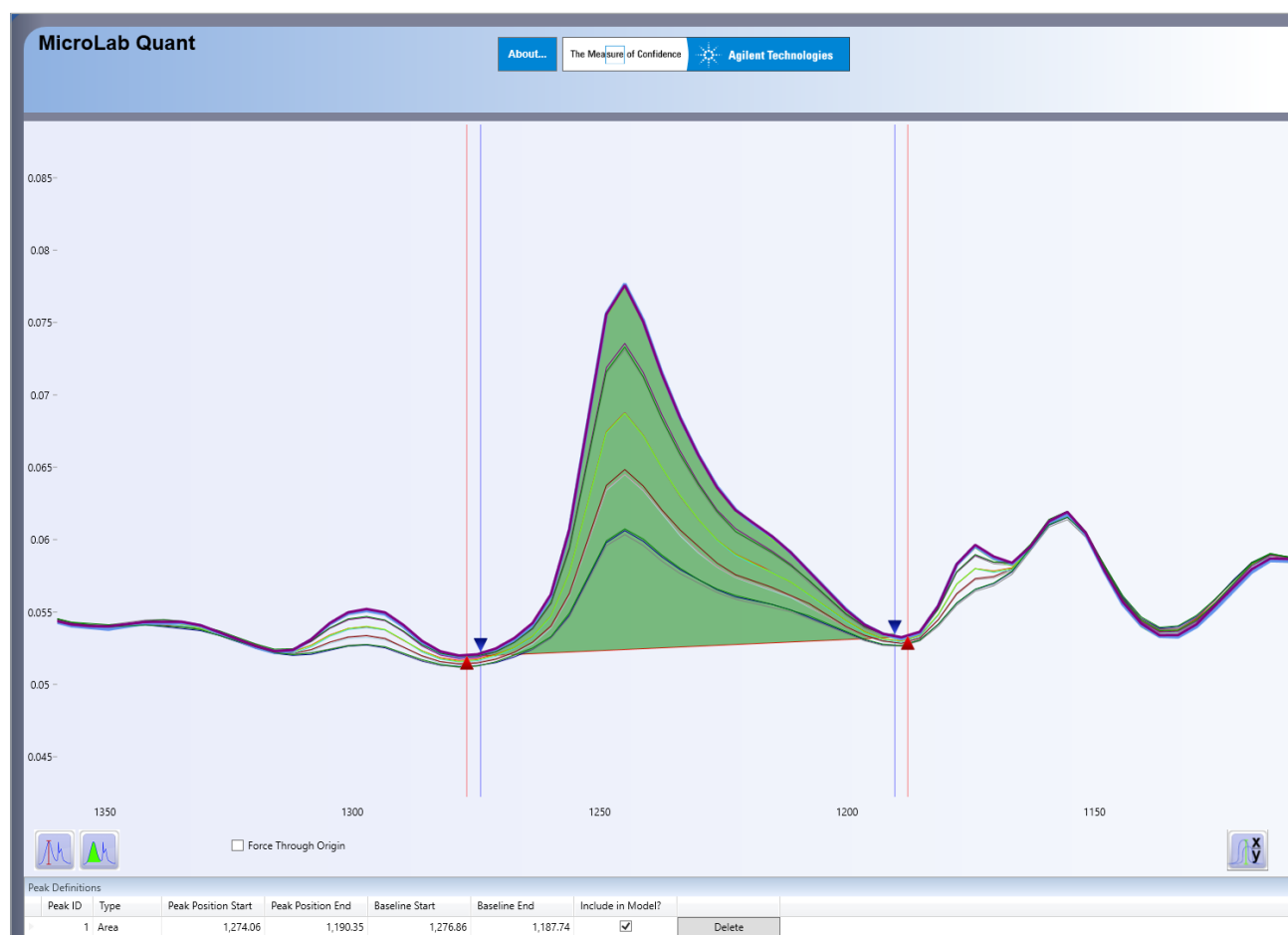
図 3. Agilent MicroLab Quant アプリケーションにより、分析対象物の定量に最適なバンドを特定し、ピーク位置、ピークの開始ポイントと終了ポイントなどの分析パラメータを最適化できます。フェノキシエタノールの場合は 1250\text{ cm}^{-1} のバンドが特異的で、検量線生成に適しています。
