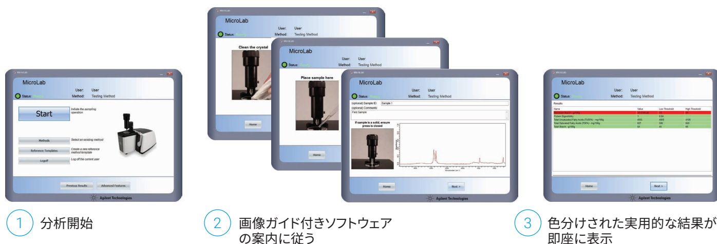
図 2. Agilent MicroLab ソフトウェアと Agilent FTIR 分光光度計を使用することで、3 つのシンプルな手順で分析を実行でき、メソッドを効率化して必要なトレーニングを大幅に低減できます。
