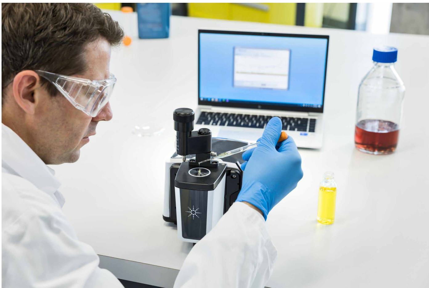
図 1. Agilent Cary 630 FTIR 分光光度計とダイヤモンド ATR モジュールは、ハンドウォッシュ製品に含まれるフェノキシエタノールの迅速、簡単な定量に最適です。
