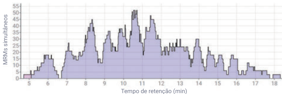
Figura 2. A distribuição de 614 transições de MRM com até 52 MRMs simultâneos monitorados durante a análise, permitindo uma distribuição mais eficiente de mínimo de dwell time para MRM.
