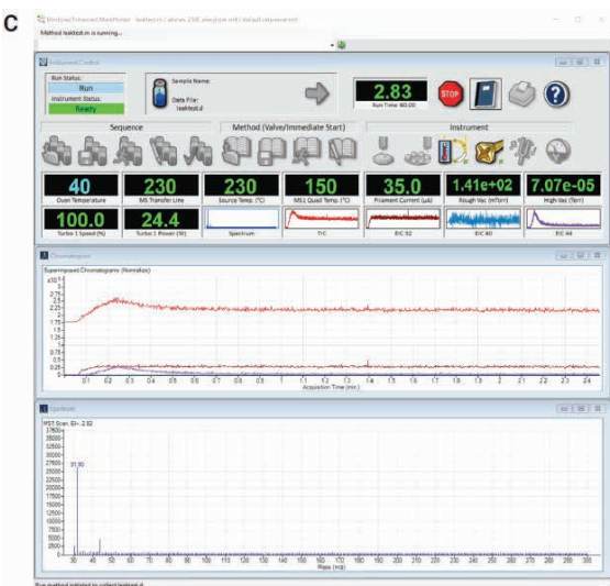
図 7. ユーザーが指定したイオンをモニタリングしてリーク源とリーク量を突き止めることのできる新しいリークテストツール
