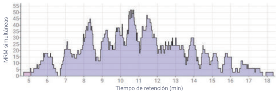
Figura 2. La distribución de 614 transiciones MRM con hasta 52 MRM simultáneas monitorizadas durante el análisis que permite una distribución del tiempo de residencia con la máxima eficacia.
