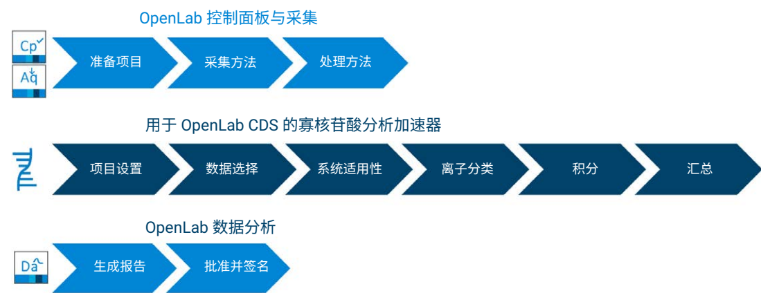
图 1. 按数据系统划分的纯度、含量和杂质分析工作流程及其包括的步骤。使用 Agilent InfinityLab LC/MSD XT 在 Agilent OpenLab CDS 软件中进行采集。在网页应用程序中进行数据处理。然后在 OpenLab CDS 中进行报告
