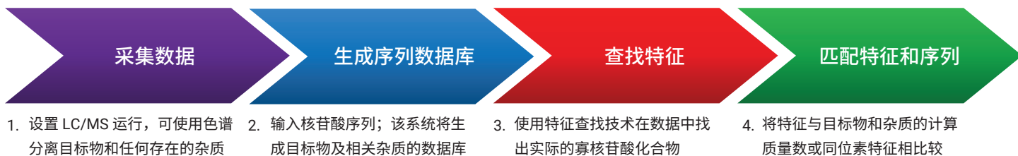
图 2. Agilent MassHunter BioConfirm 软件 12.0 版中的目标物与杂质 (TPI) 数据分析工作流程
