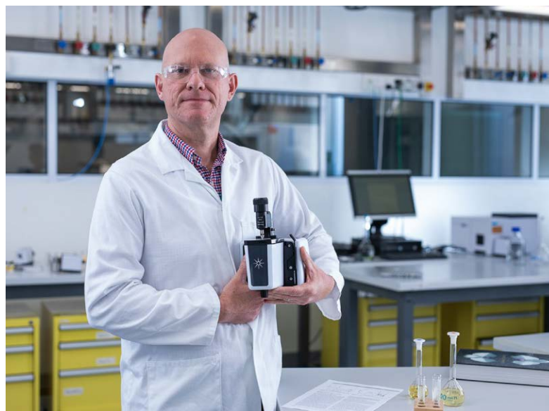
图 2. 配备钻石晶体衰减全反射采样模块的 Agilent Cary 630 FTIR 光谱仪
