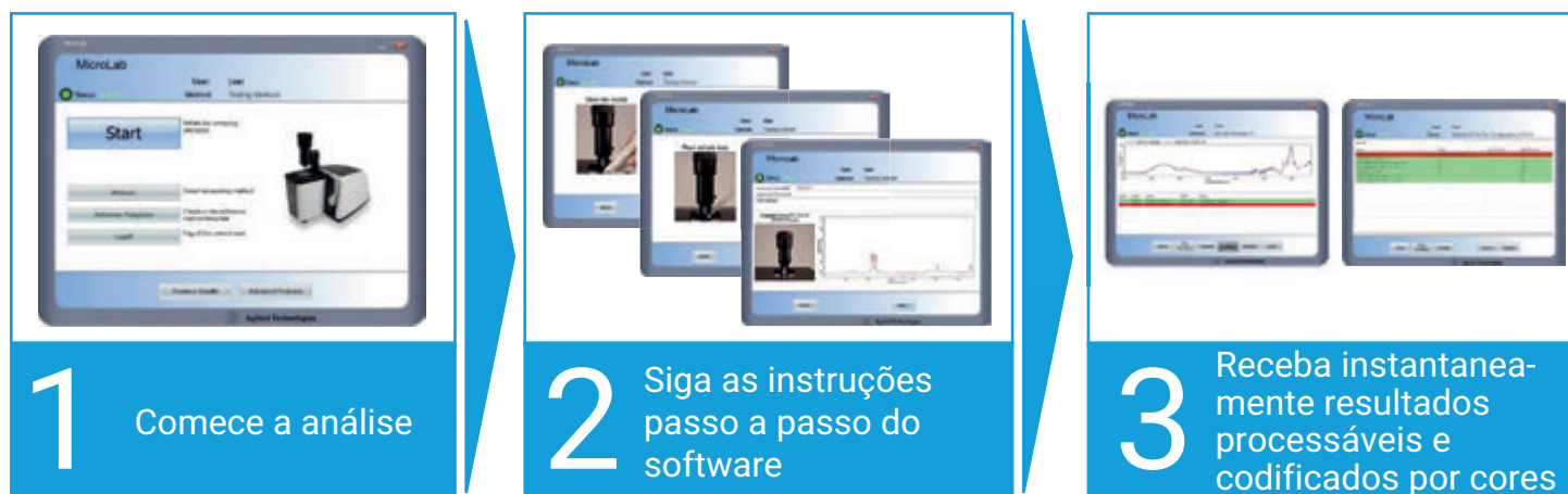
Figura 3. O software Agilent MicroLab reconhece automaticamente o módulo de amostragem conectado e aplica os parâmetros adequados. O software guia o usuário, passo a passo, pelo fluxo de trabalho analítico usando imagens instrutivas. Os resultados são codificados por cores e exibidos diretamente após a aquisição de dados, tornando a revisão de dados rápida e intuitiva.
