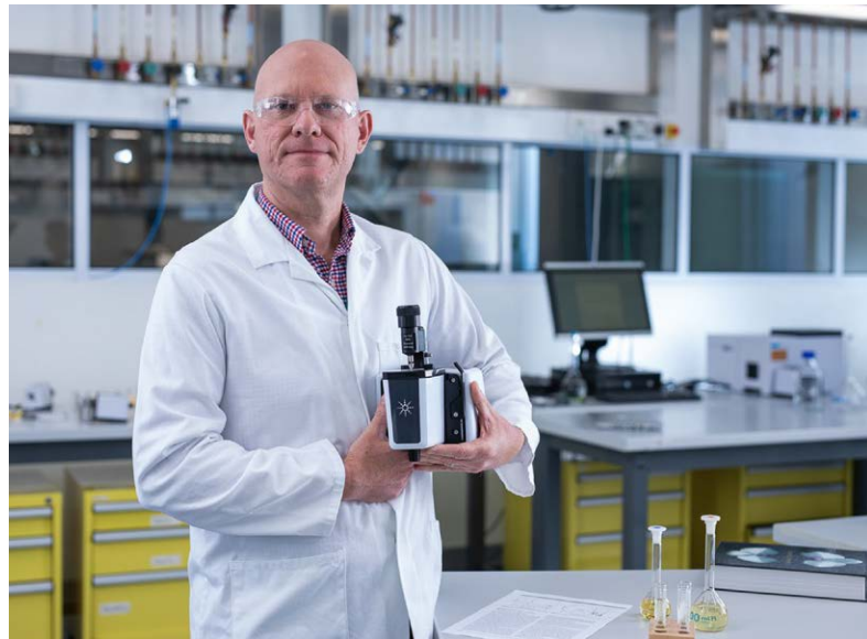
그림 2. 다이아몬드 감쇠 전반사 샘플링 모듈이 장착된 Agilent Cary 630 FTIR 분광기.
