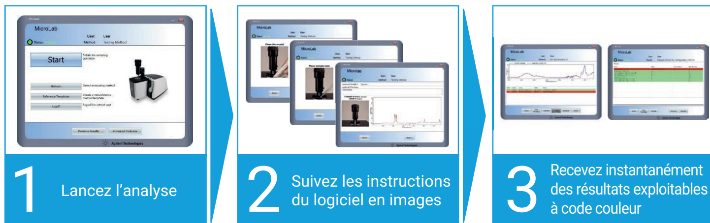
Figure 3. Le logiciel Agilent MicroLab reconnaît automatiquement le module d'échantillonnage fixé et applique les paramètres appropriés. Le logiciel guide l'utilisateur à travers chaque étape de la méthode analytique à l'aide d'images explicatives. Les résultats à code couleur, rapportés directement après l'acquisition des données, rendent rapide et intuitive la révision des données.
