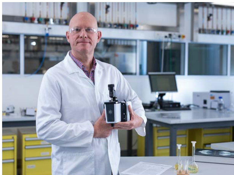
Figure 2. Spectromètre FTIR Agilent Cary 630 équipé du module d'échantillonnage de réflexion totale atténuée en diamant.
