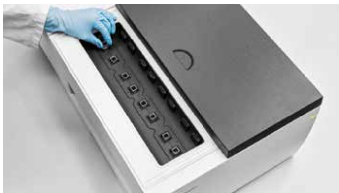
Figura 1. Se utilizó un espectrofotómetro UV-Vis Agilent Cary 3500 Multicell para todas las mediciones.
