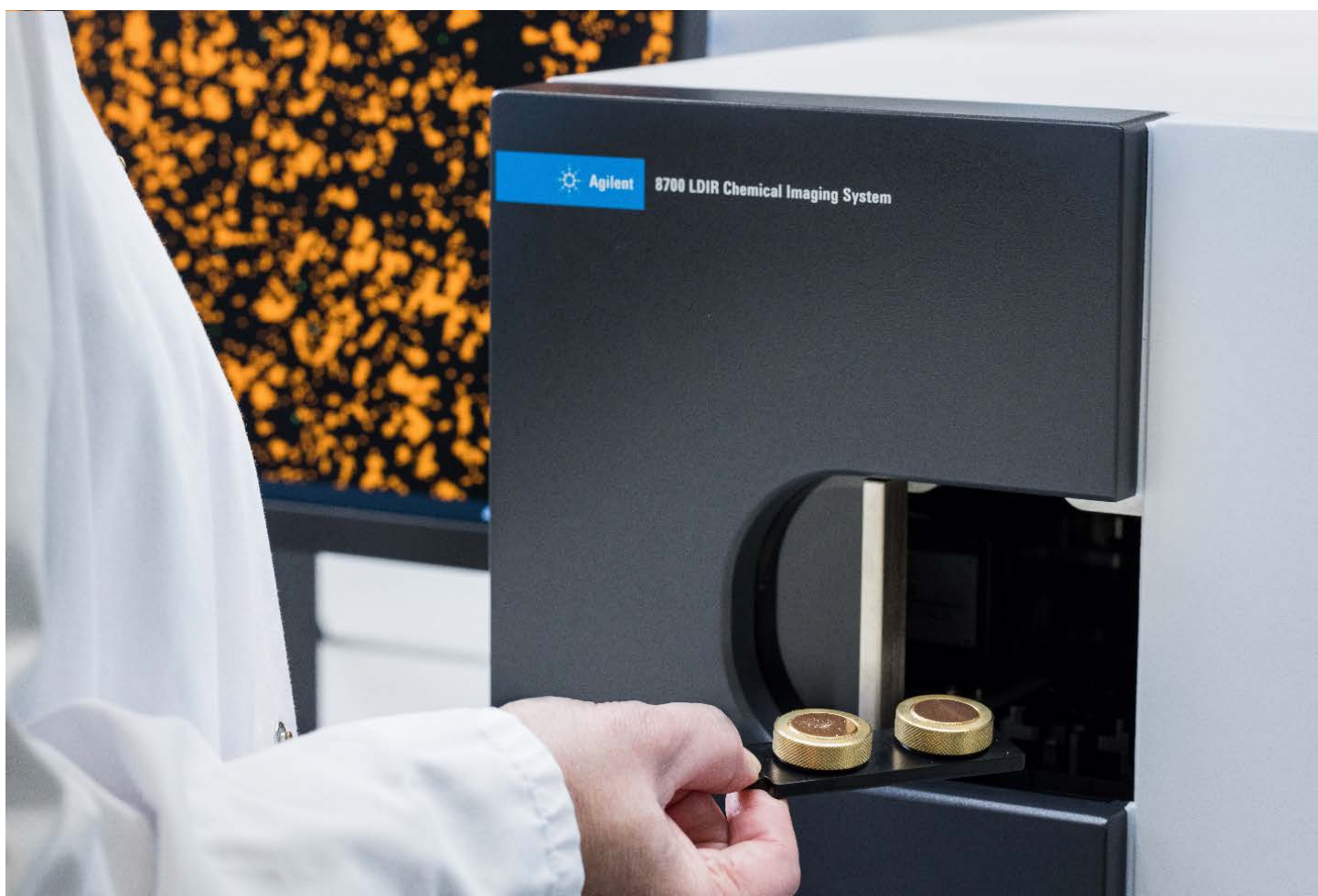
图 1. Agilent 8700 LDIR 化学成像系统可对微塑料进行高速常规分析，包括样品中存在的颗粒数量、样品大小和化学组成
