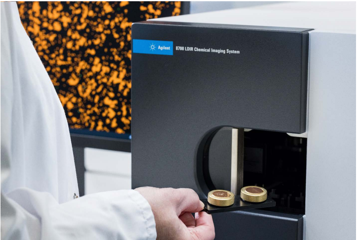
그림 1. Agilent 8700 LDIR 화학 이미징 시스템을 사용하면 샘플에 존재하는 입자 수, 입자 크기 및 화학적 조성을 포함하여 미세플라스틱에 대한 일상적인 고속 분석이 가능합니다.
