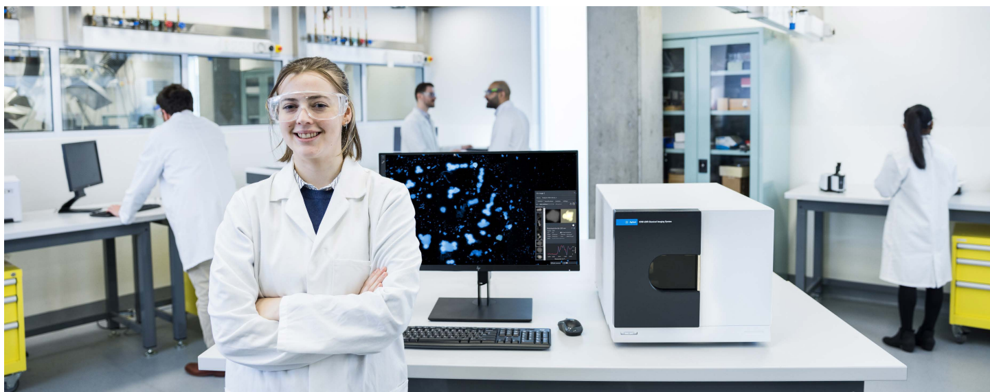
图 1. Agilent 8700 LDIR 化学成像系统可对微塑料进行高速常规分析，包括样品中存在的颗粒数量、样品大小和化学组成
