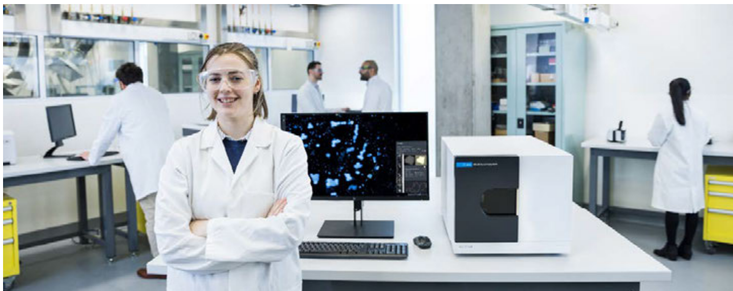
Figure 1. Le système d'imagerie chimique LDIR Agilent 8700 permet d'effectuer une analyse de routine des microplastiques à grande vitesse. Il fournit notamment le nombre de particules présentes dans l'échantillon, leur taille et leur composition chimique.
