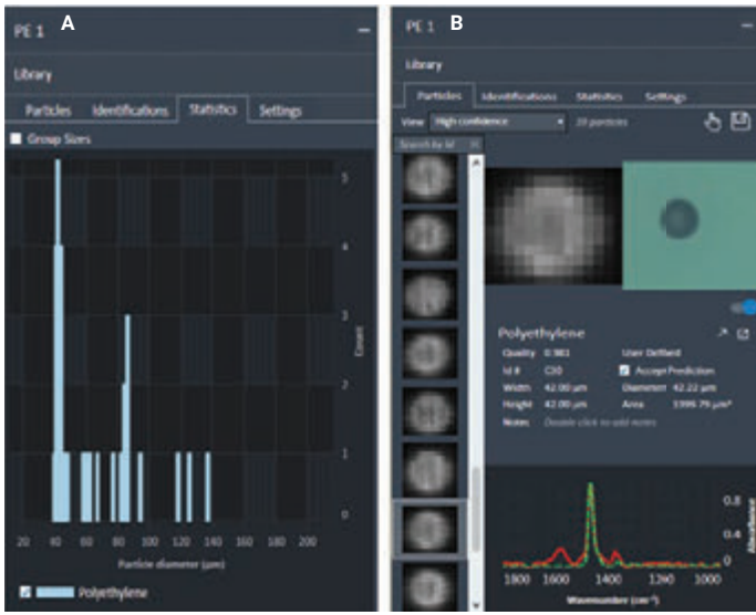
Abbildung 4. (A) Statistische Daten der Mikroplastikpartikel auf der Grundlage verschiedener Größenbereiche. (B) Beispiel für Polyethylenpartikel; Partikelinformationen wie Infrarotbild, sichtbares Bild, HQI, Größe und Überlappung des Spektrums (durchgezogene rote Linie) mit dem übereinstimmenden Bibliotheksspektrum (grüne gestrichelte Linie) können angezeigt werden.
