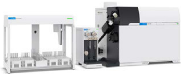
Abbildung 1. Agilent 7850 ICP-MS mit dem automatischen Verdünnungssystem ADS 2 von Agilent und automatischen Probengeber Agilent SPS 4.
