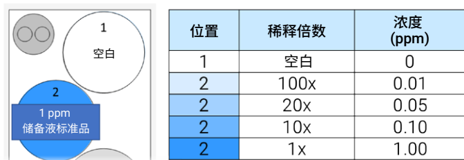
图 2. 标准储备液放入 Agilent SPS 4 自动进样器标准样品架位置 2 处, 使用 Agilent ADS 2 对标准储备液进行不同稀释倍数的自动配标
