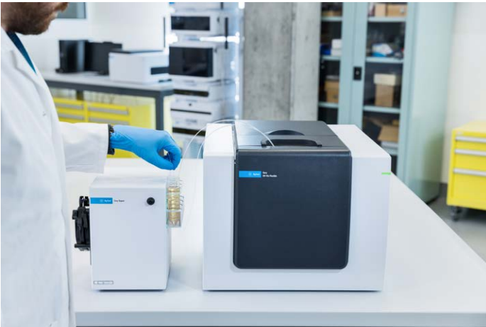
图 1. 配备 Agilent Cary 蠕动泵附件（左）和流通池（位于 Cary 3500 样品室内部）的 Agilent Cary 3500 多功能紫外-可见分光光度计是危险液体分析的理想之选。这种配置可确保操作人员的安全，同时大幅提高样品通量并节省大量时间
