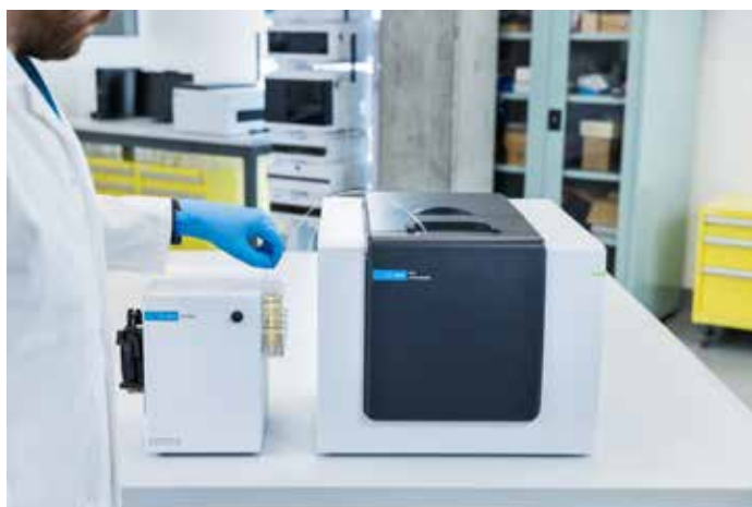
Figura 1. Lo spettrofotometro UV-Vis flessibile Agilent Cary 3500 dotato di pompa accessoria Agilent Cary Sipper (a sinistra) e cella a flusso (posizionata all'interno del vano per i campioni di Cary 3500) è ideale per l'analisi di liquidi pericolosi. Questa configurazione garantisce la sicurezza dell'operatore, massimizzando la produttività in termini di campioni analizzati e ottenendo un significativo risparmio di tempo.
