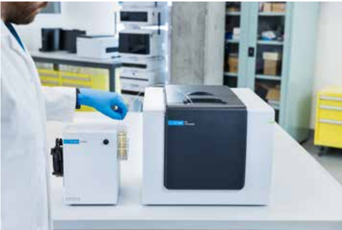
Figure 1. Le spectrophotomètre UV-Vis Agilent Cary 3500 Flexible équipé de la pompe péristaltique Agilent Cary disponible en option (à gauche) et d'une cuve à circulation (située à l'intérieur du compartiment à échantillon du Cary 3500) est parfaitement adapté aux analyses de liquides dangereux. Cette configuration garantit la sécurité de l'utilisateur, permet des gains de temps significatifs et d'optimiser la cadence d'analyse des échantillons.
