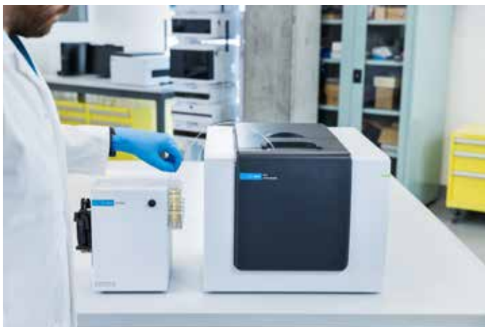
Abbildung 1. Das Agilent Cary 3500 Flexible UV-Vis-Spektralphotometer mit Agilent Cary Sipper-Pumpe als Zubehör (links) und Durchflusszelle (im Probenfach des Cary 3500) ist ideal für die Analyse gefährlicher Flüssigkeiten. Diese Anordnung gewährleistet die Sicherheit des Bedieners, während der Probendurchsatz maximiert und eine erhebliche Zeitersparnis erzielt wird.
