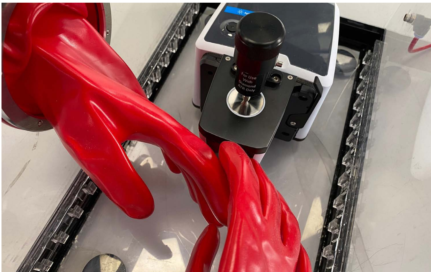
图 1. Cary 630 FTIR 光谱仪非常小巧、轻便 (20 × 20 cm, 重 3.6 kg)，易于操作并可根据样品进行放置，确保获得高质量结果
