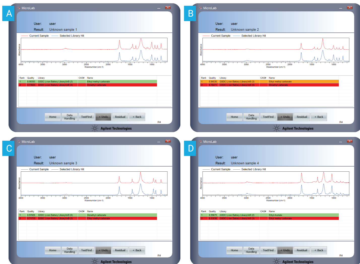
图 4. Agilent Cary 630 FTIR 光谱仪对 4 种 LIB 溶剂样品的鉴定分析结果 (红色曲线) 以及谱库匹配结果 (蓝色曲线)。表中显示了未知样品 1 至 4 的匹配质量、所用谱库和匹配结果名称 (分别标记为 A 至 D)
