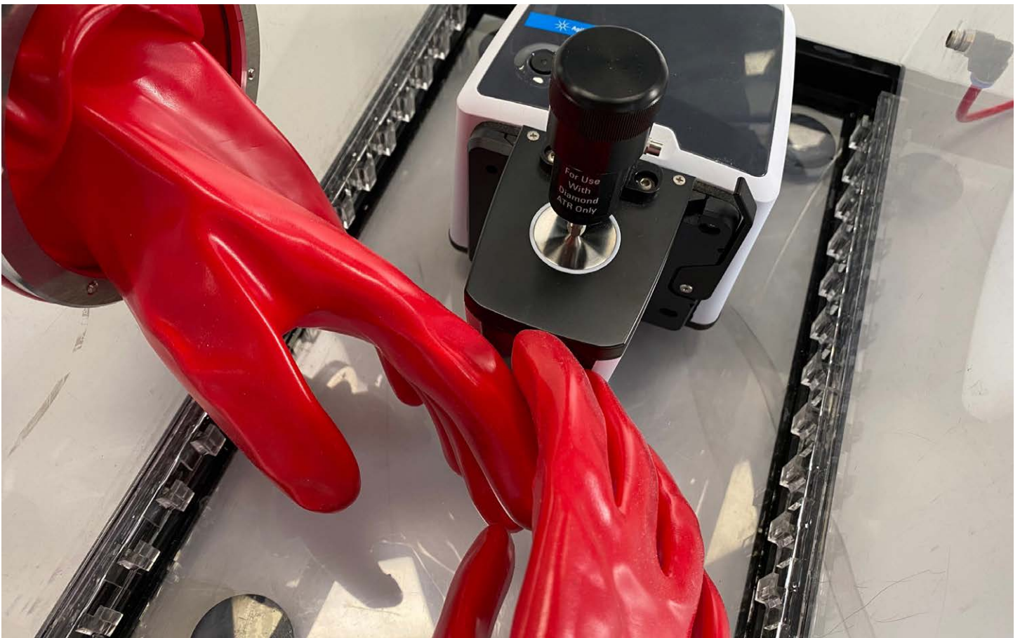
그림 1. Cary 630 FTIR 분광기는 초소형 경량 디자인(20 x 20cm, 3.6kg)으로 시료에 맞춰 쉽게 다루기 쉽고 배치할 수 있어 고품질의 결과를 약속합니다.
