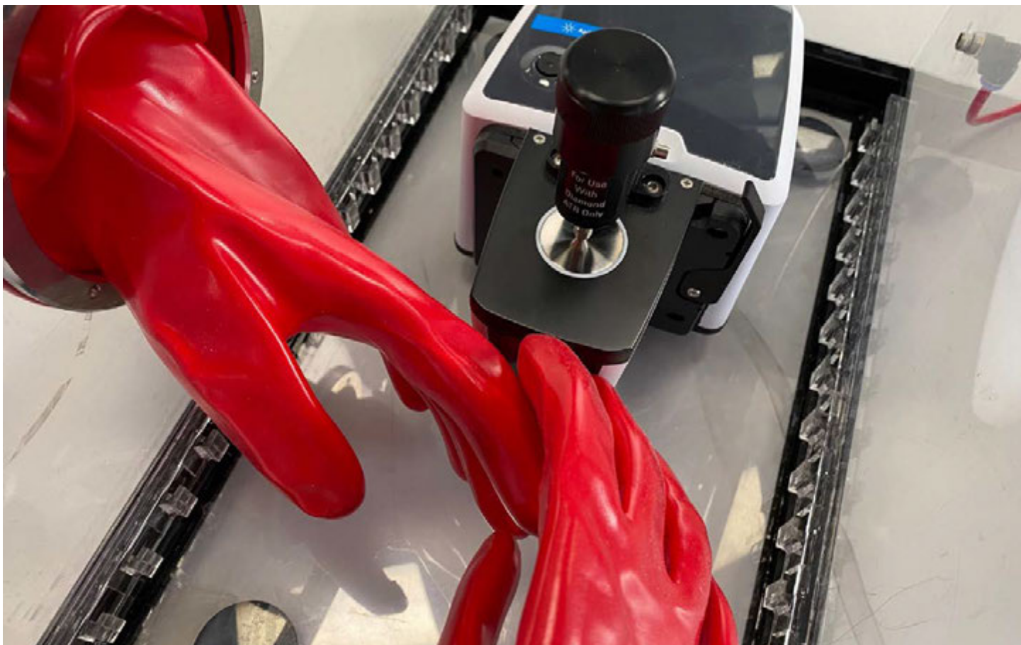
Figura 1. El espectrómetro FTIR Cary 630, con su diseño ultracompacto y ligero (20 x 20 cm y 3.6 kg), puede manejarse y colocarse fácilmente en relación con la muestra, lo que garantiza unos resultados de alta calidad.
