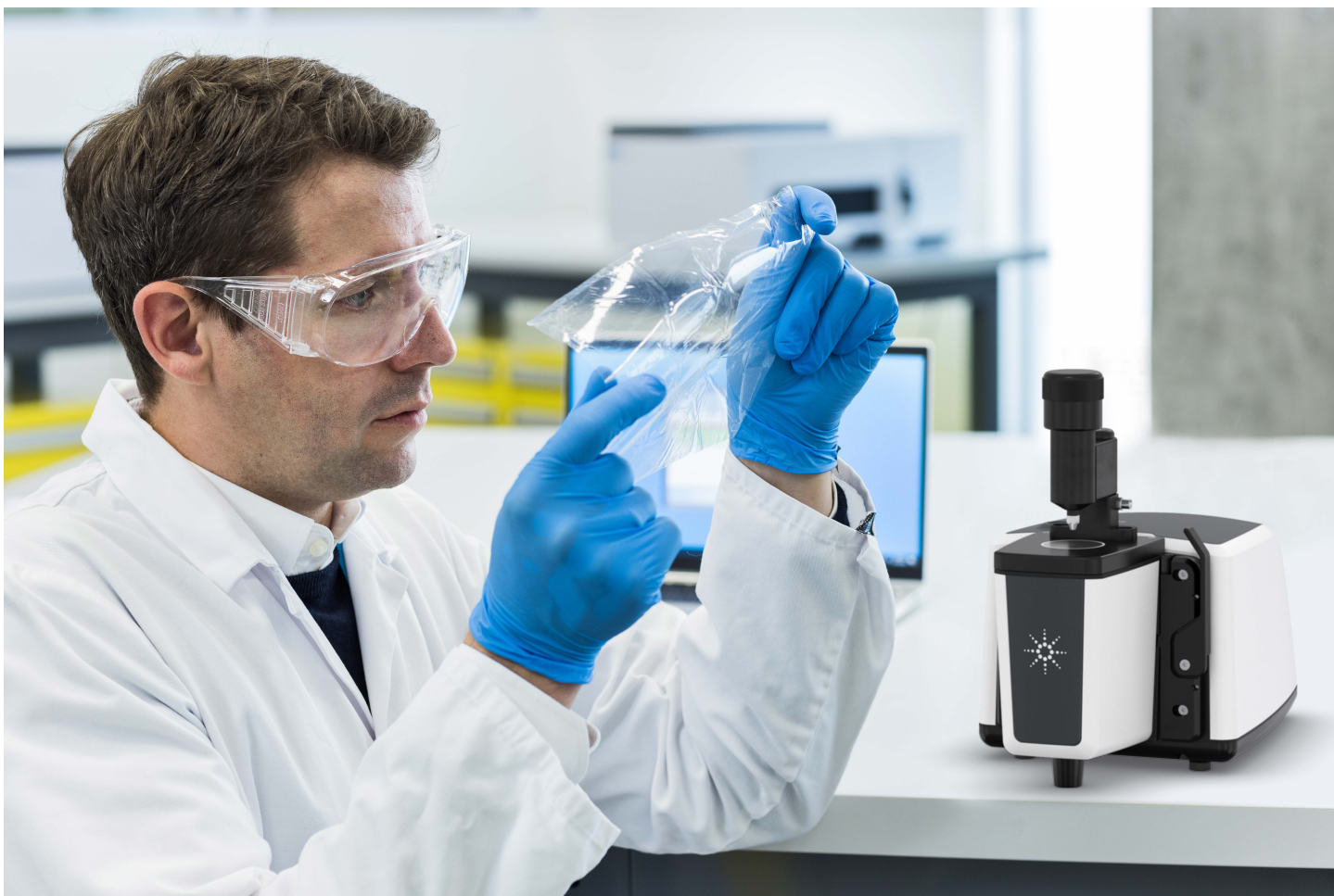
图 1. 配备 ATR 采样模块的 Agilent Cary 630 FTIR 光谱仪，适用于鉴定聚合物和薄膜
