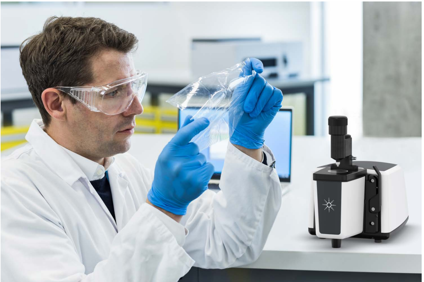
그림 1. 폴리머 및 박막 식별에 사용되는 ATR 샘플링 모듈이 장착된 Agilent Cary 630 FTIR 분광기.
