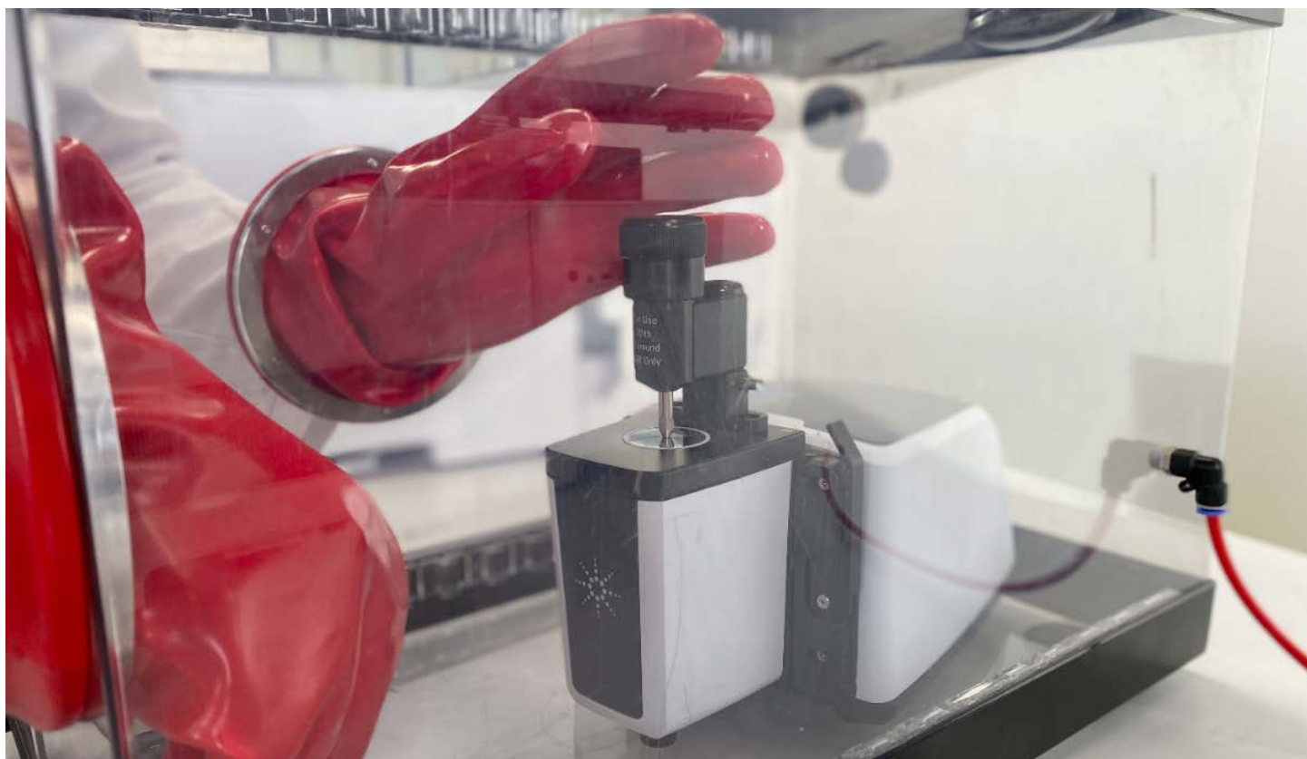
图 1. Agilent Cary 630 FTIR 光谱仪采用超小巧、轻便的设计（20 × 20 cm，重 3.6 kg），可以方便地在手套箱中使用，以获得高质量结果
