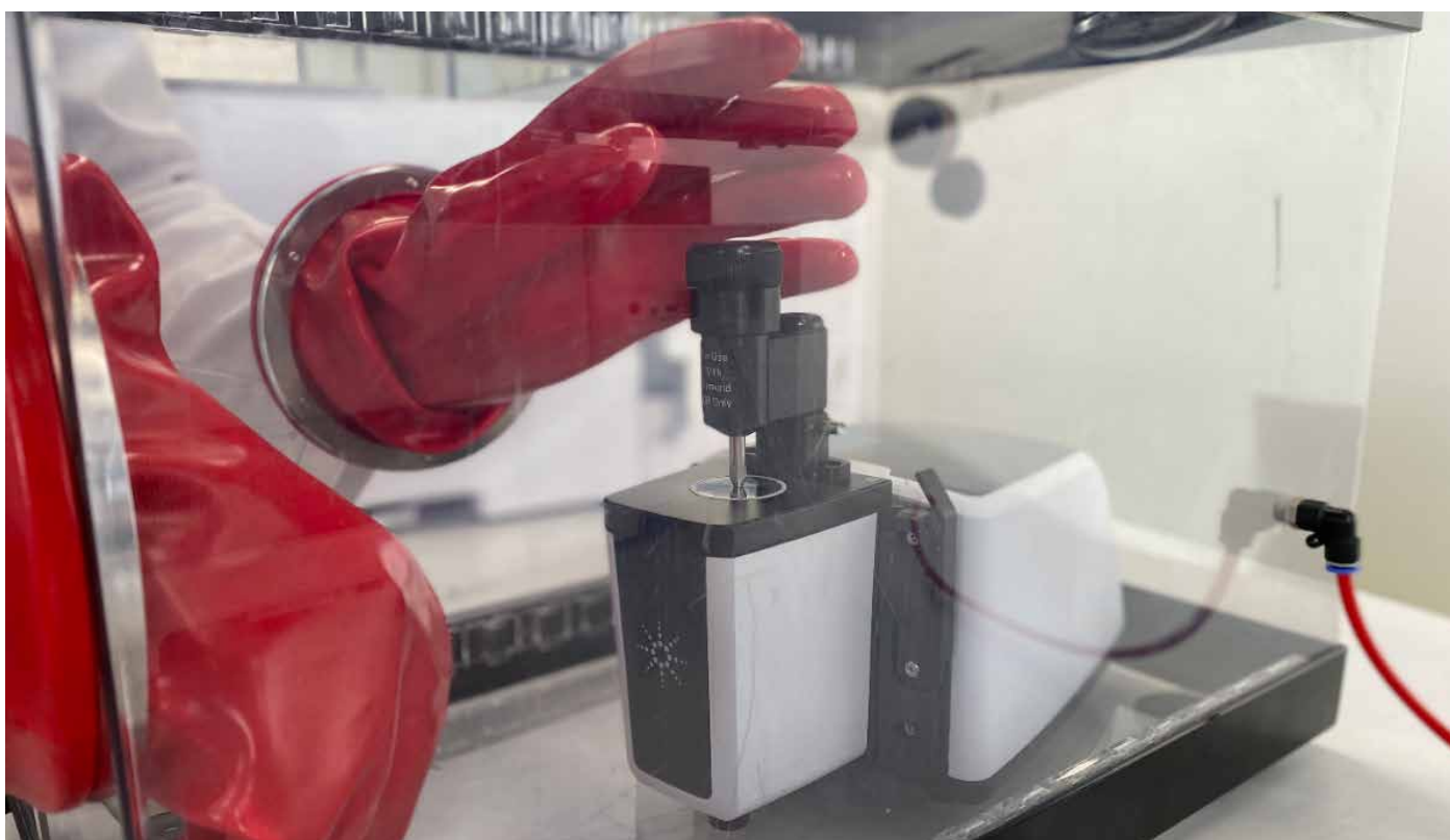
図 1. 超コンパクトで軽量の設計 (20 × 20 cm、3.6 kg) の Agilent Cary 630 FTIR 分光光度計は、グローブボックス内で簡単に使用でき、高品質の結果を生成します。
