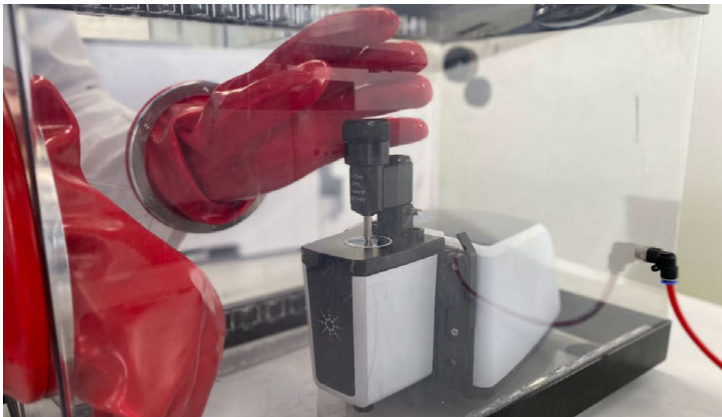
Figura 1. El espectrómetro FTIR Agilent Cary 630, con su diseño ultracompacto y ligero (20 x 20 cm y 3.6 kg), puede utilizarse fácilmente en una caja de guantes para obtener resultados de alta calidad.
