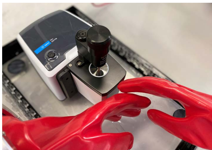
图 1. Agilent Cary 630 FTIR 光谱仪采用超小巧、轻便的设计 (20 × 20 cm, 重 3.6 kg)，可以方便地在手套箱中使用，为湿敏性或危险化学品提供高质量结果
