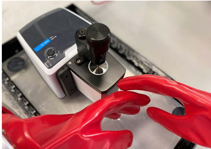
그림 1. Agilent Cary 630 FTIR 분광기는 초소형 경량 디자인(20 × 20cm 및 3.6kg)으로 글러브 박스에서 쉽게 사용하여 습기에 민감하거나 유해한 화학물질에 대한 고품질 결과를 얻을 수 있습니다.
