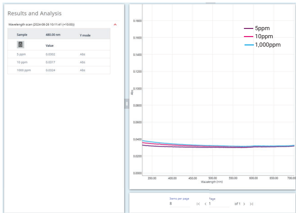
그림 2. Agilent Cary 3500 멀티셀 UV-Vis 분광 광도계를 사용하여 측정된 LiCl 수용액(5, 10 및 1,000ppm)의 UV-Vis 스펙트럼. 시료는 공기에 대해 베이스라인 보정되었습니다.
