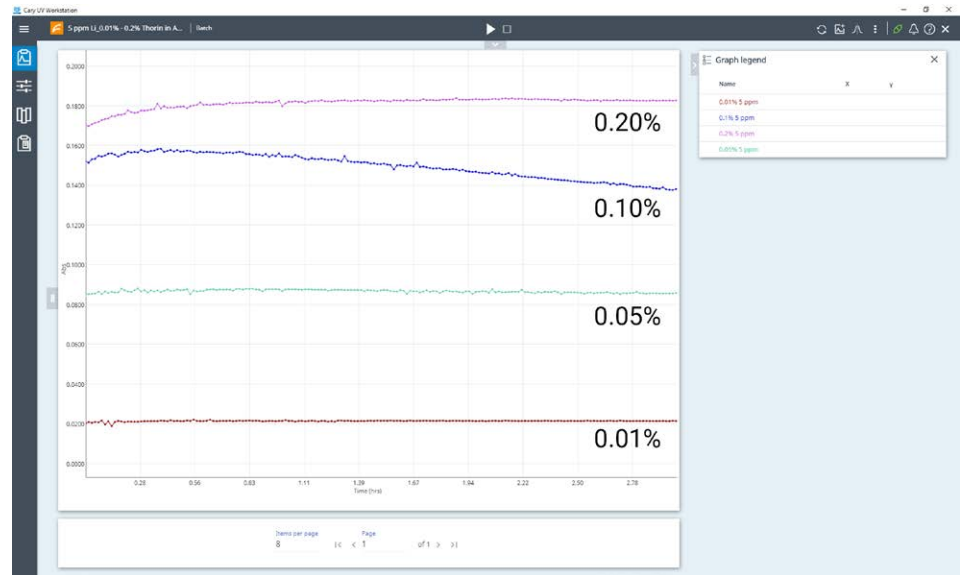
그림 4. 아세톤에 다양한 토린 농도(0.01-0.2%)를 첨가하여 제조한 5ppm Li 표준물질 4개. Agilent Cary 3500 멀티셀 UV-Vis 분광 광도계의 멀티존 기능을 사용하여 480nm에서의 흡광도를 동시에 모니터링했습니다.
