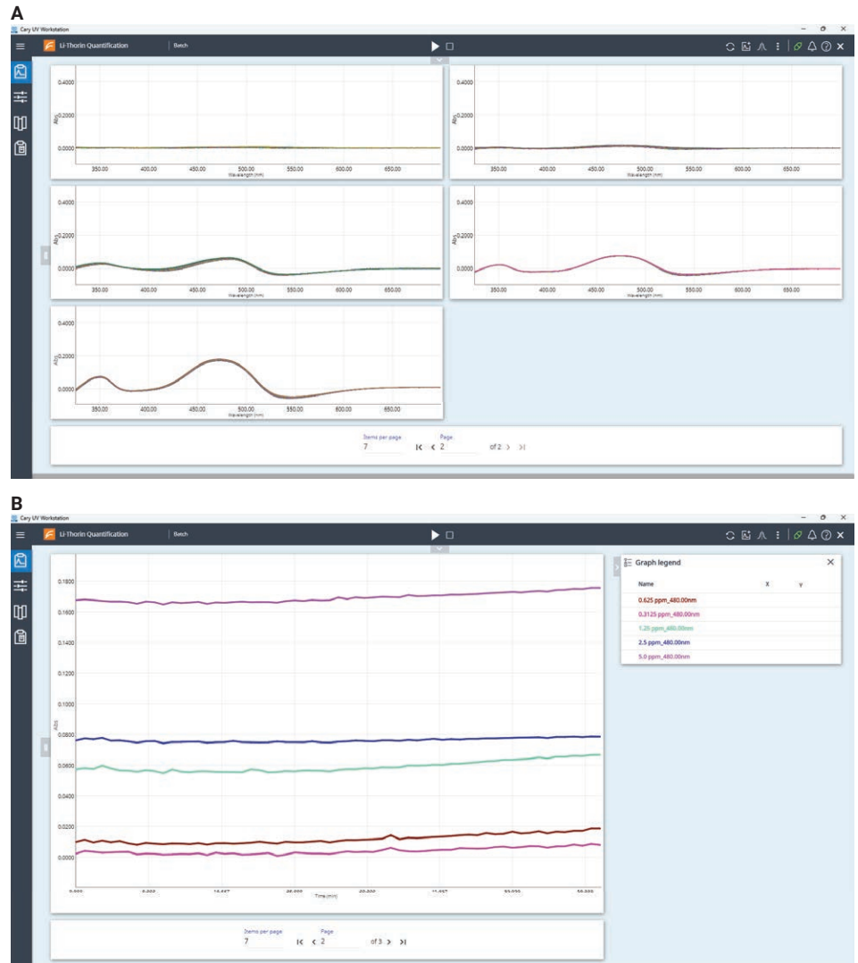
그림 6. 5가지 LiCl 표준물질(아세토니트릴 및 0.2% 토린에서 제조)의 반응 키네틱을 60분 동안 모니터링했습니다. (A) 파장 범위 스캔 및 (B) 480nm 단일 파장 스캔. Agilent Cary 3500 멀티셀 UV-Vis를 사용하면 최대 7개의 시료를 동시에 모니터링할 수 있습니다.
