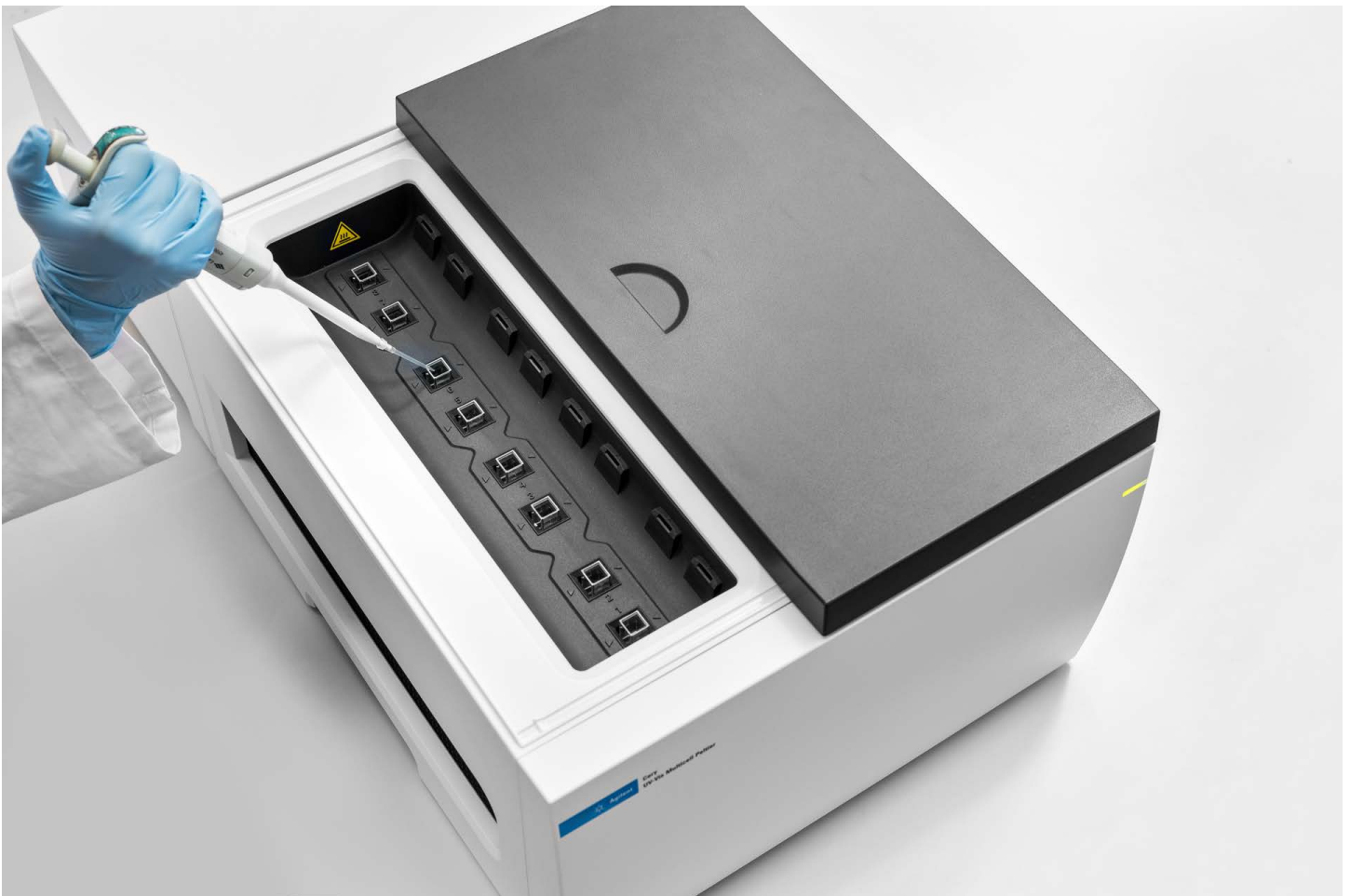
그림 1. 온도 제어식 멀티존 모듈이 장착된 Agilent Cary 3500 멀티셀 UV-Vis 분광 광도계.
