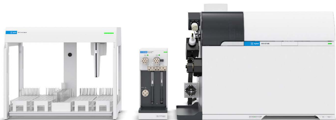
图 1. 配备集成 AVS MS（右）、Agilent ADS 2 自动稀释器（中）和 Agilent SPS 4 自动进样器（左）的 Agilent 7850 ICP-MS
