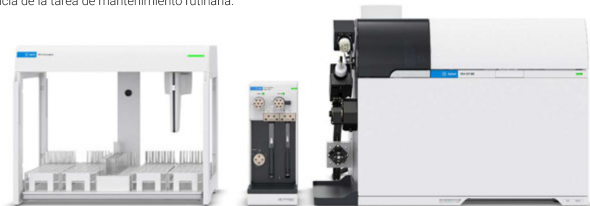
Figura 1. ICP-MS Agilent 7850 con AVS MS integrado (derecha), diluidor automático ADS 2 Agilent (centro) y muestreador automático Agilent SPS 4 (izquierda).
