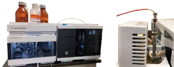
図 1. デュアル注入ニードル搭載の Agilent 1290 Infinity II マルチサンプラを用いた高速 LC メソッド
