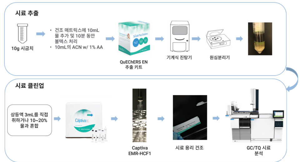
그림 3. 전통적인 방식의 Agilent QuEChERS 추출 및 뒤이은 Agilent Captiva EMR 패스스루 클린업을 통한 시료 전처리 흐름도.
