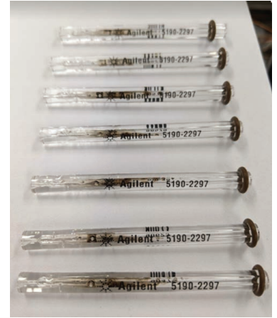
그림 8. (A) 시금치 추출물에 대해 수집한 전체 스캔 크로마토그램의 TIC 및 20ppb 농약에 대한 MRM TIC. (B) 견고성 평가 과정에서 시금치 추출물을 분석할 때 100회 주입 후 GC 주입구 라이너 교체.
