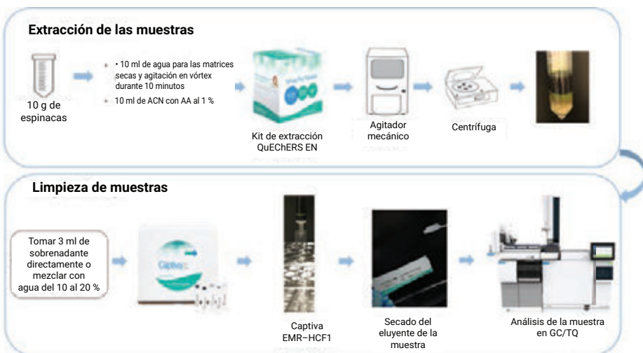
Figura 3. Diagrama de flujo de la preparación de muestras con extracción QuEChERS convencional de Agilent seguida de una limpieza de paso Agilent Captiva EMR.
