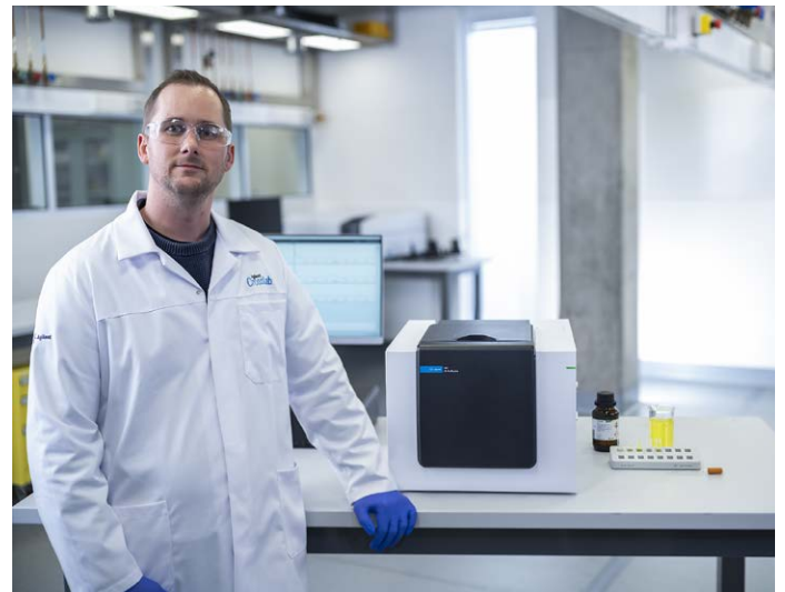
그림 1. Agilent Cary 3500 Flexible UV-Vis 분광 광도계는 공구가 필요 없는 가변 경로 길이 직사각형 및 원통형 셀 홀더를 사용하여 최대 10cm의 다양한 경로 길이에서 액체 시료 측정을 지원합니다.
